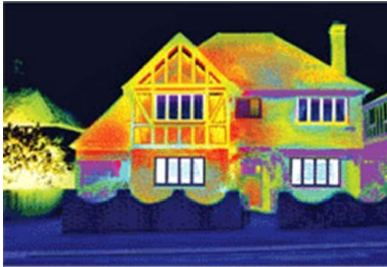
Antes de sellar el envolvente del edificio
